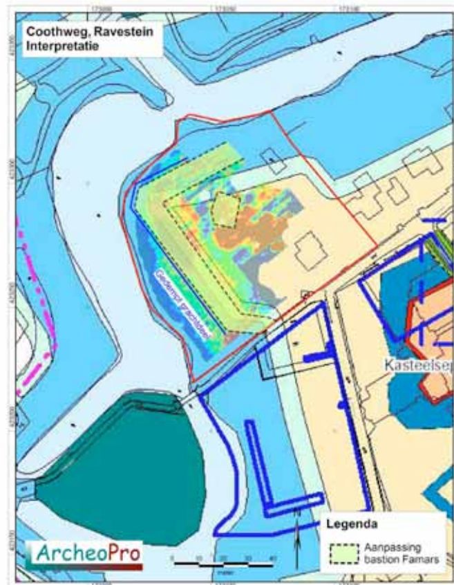
Figuur 20. De resultaten van de weerstandsmetingen geprojecteerd op de gemeentelijke beleidskaart met daar bovenop de ligging van bastion Famars gecorrigeerd aan de hand van de meet- en boorresultaten.
